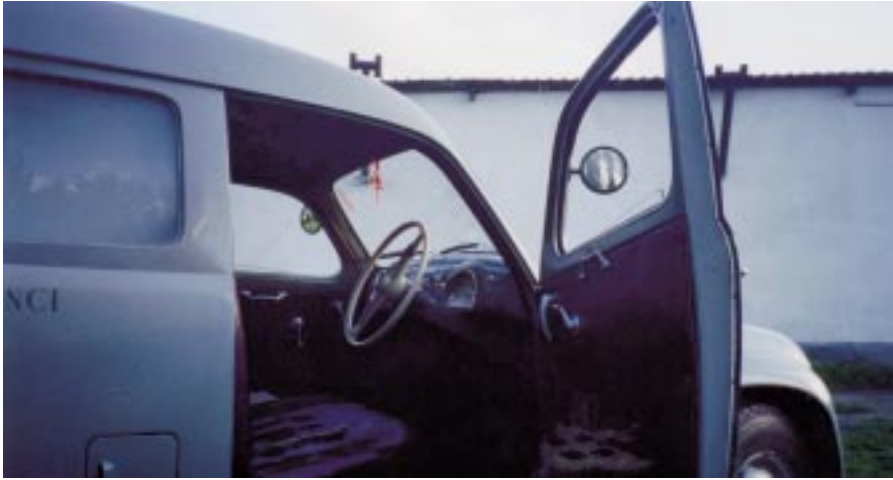
I comandi "all'inglese" sono una caratteristica più che singolare per una produzione italiana.
