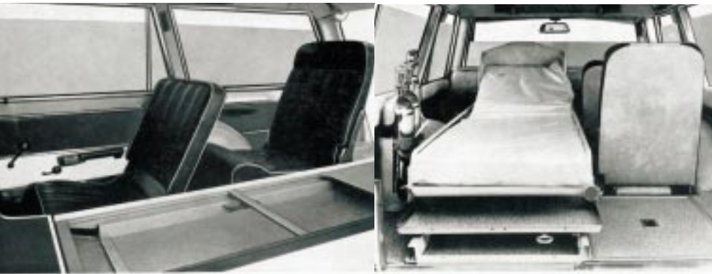
Vano sanitario visto dalla parte interna laterale, di cui si può notare la piattaforma scorrevole (Grazia)
