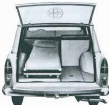
Fiat 1800 - Portello posteriore a due battenti, uno superiore, e uno inferiore.
