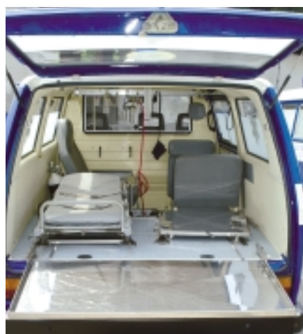
Accorgimento tipico del piatto di estrazione fatto calare dopo l'apertura del portellone.
